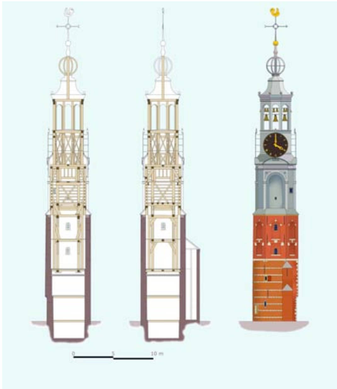
Doorsneden en aanzicht van de Munttoren (tekening Dik de Roon/ BMA).
