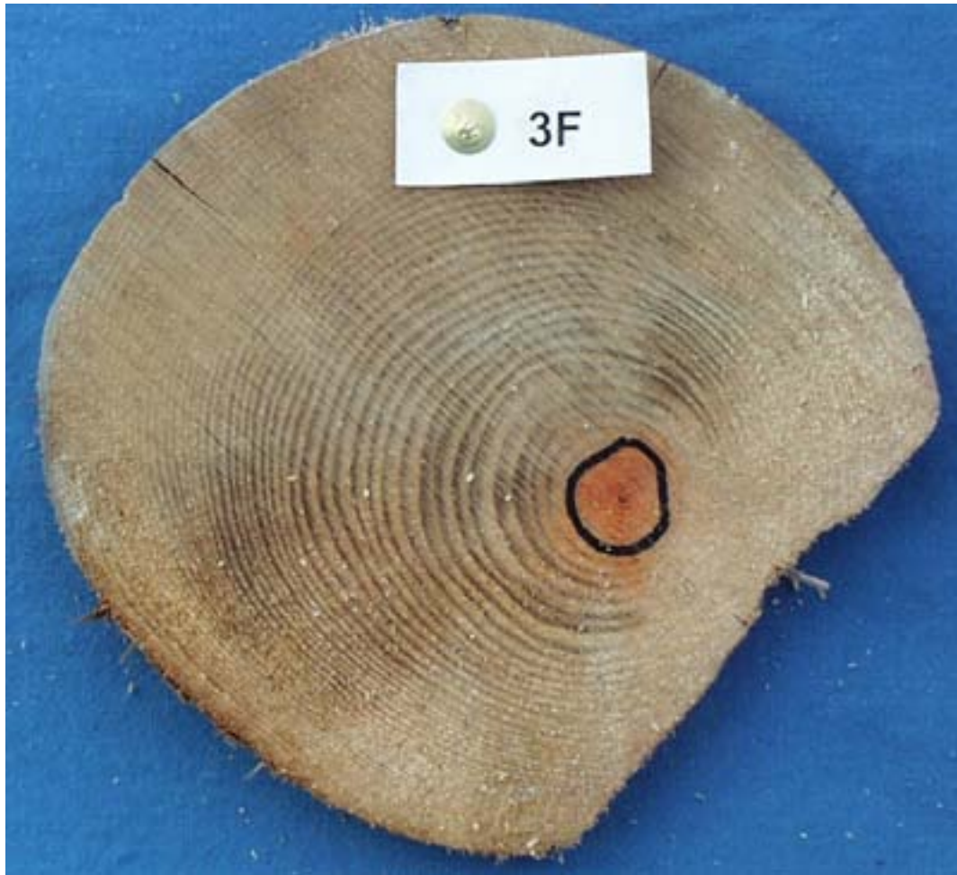
Een extreem voorbeeld van weinig kernringen (6) en veel spintringen (50) in Nederlands grenen (foto René Klaassen/ Stichting Hout Research).
